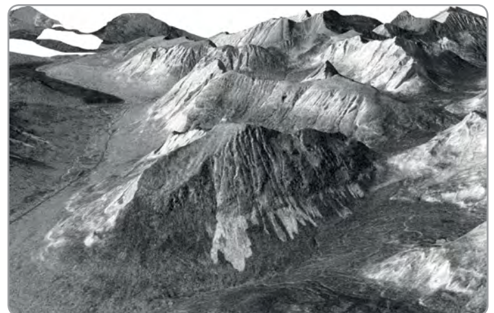
Vue 3D d'une image de rétrodiffusion radar Sentinel-1 ; les avalanches sont visibles au premier plan en gris clair.
