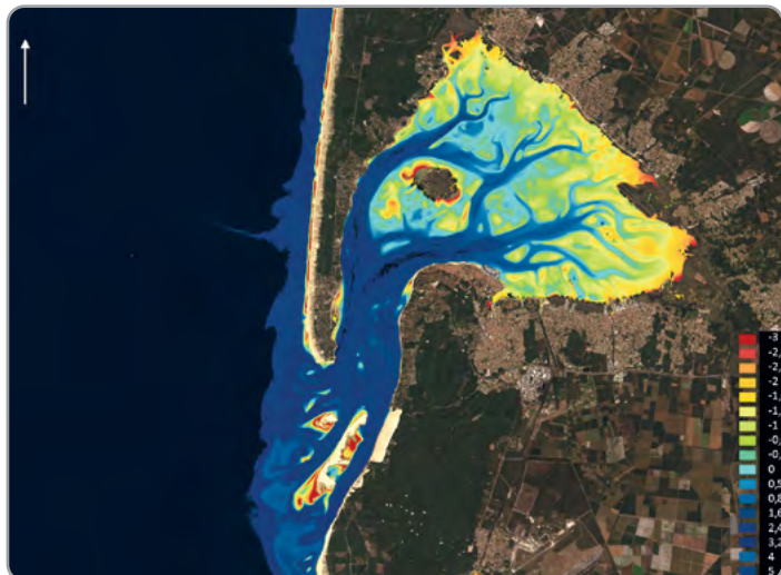
Batimetria satellitare della Baia di Arcachon, ricavata dalle immagini di Sentinel-2A. I fondali otticamente profondi sono rappresentati in nero. Crediti: Contiene dati dei satelliti Sentinel di Copernicus modificati [2016]
